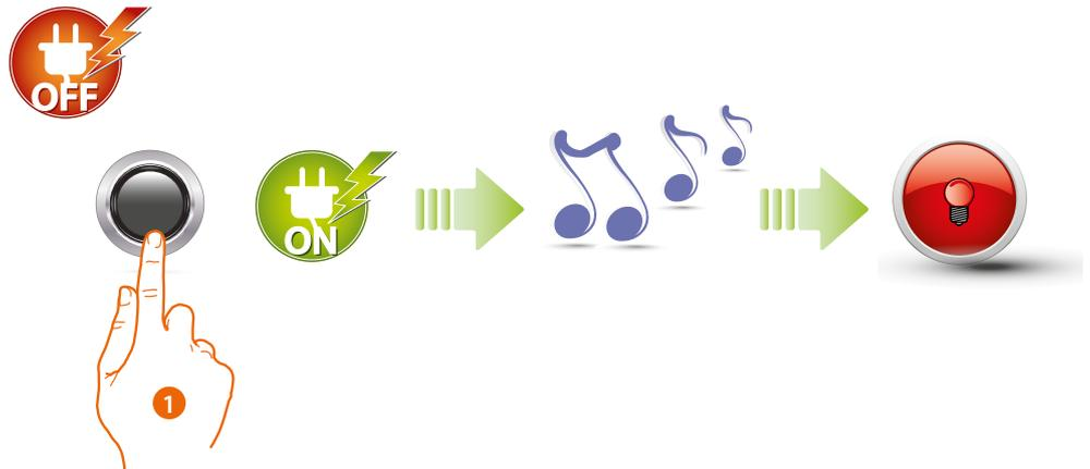
1. Halten Sie die Programmierungstaste gedrückt und stellen Sie die Stromversorgung wieder her, indem Sie die Taste so lange gedrückt halten, bis Sie einen längeren Piepton hören. Die rote LED leuchtet 4 Sekunden lang konstant und erlischt dann.
