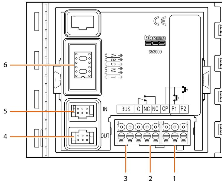
1. Anschluss Türtaste (CP-P1) und Tamper (CP-P2 - spätere Anwendung).
