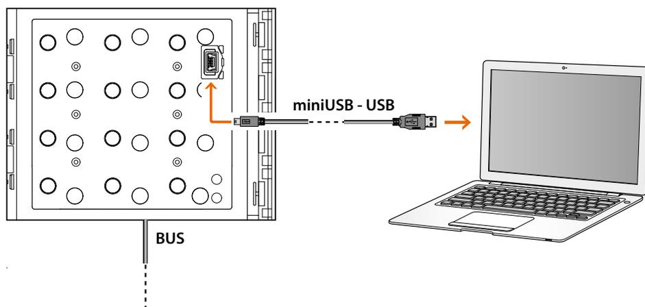
**Zum Aktualisieren der Firmware muss das Gerät gespeist.**
